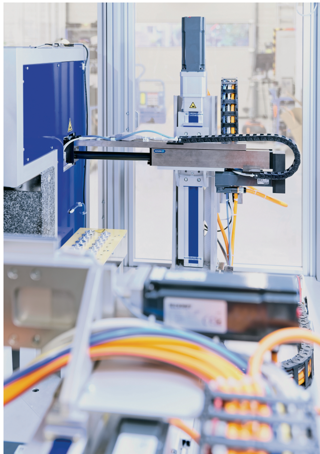
Bild 2. Achssystem: Mithilfe der kompakten Auslegerachse werden die Teile aus der Reinigungskabine entnommen und dem folgenden Präge- und Prüfprozess zugeführt.
